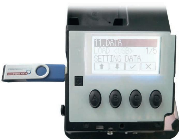
Die im Settingtool erstellten Einstellungen müssen per USB-Stick auf das Gerät übertragen werden. Somit ist das Gerät mit geringem Aufwand und maximalem Komfort eingestellt. Alle Einstellungen können per USB-Stick ausgelesen werden und auf andere Geräte übertragen werden. Somit müssen die Einstellungen nicht aufwändig an jedem ZS 6000 manuell getätigt werden, sondern können bequem einmal getätigt und weiter gegeben werden.
